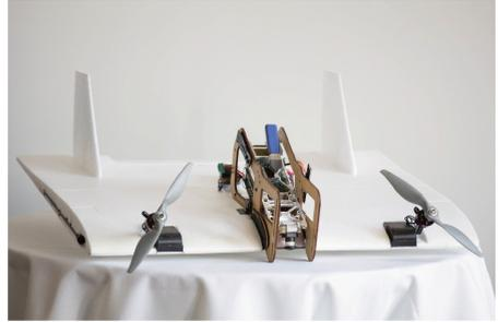
(d) Sensor & processing unit mounted on SKATE.
